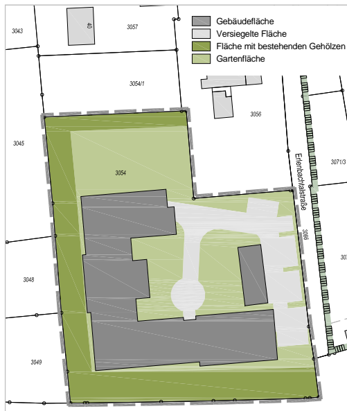
Abb. 3: Lageplan und 3D-Ansicht der geplanten Baumaßnahmen.
