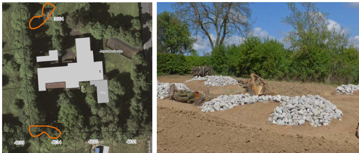
Abb. 4a und b: Lageplan (4a) der anzulegenden Steinhäufen (orange) und Beispiel (4b) für eine Anlage von Steinhäufen für Zauneidechsen ( www.bund-bretten.de ) als Maßnahme zur Vermeidung und Minimierung.
